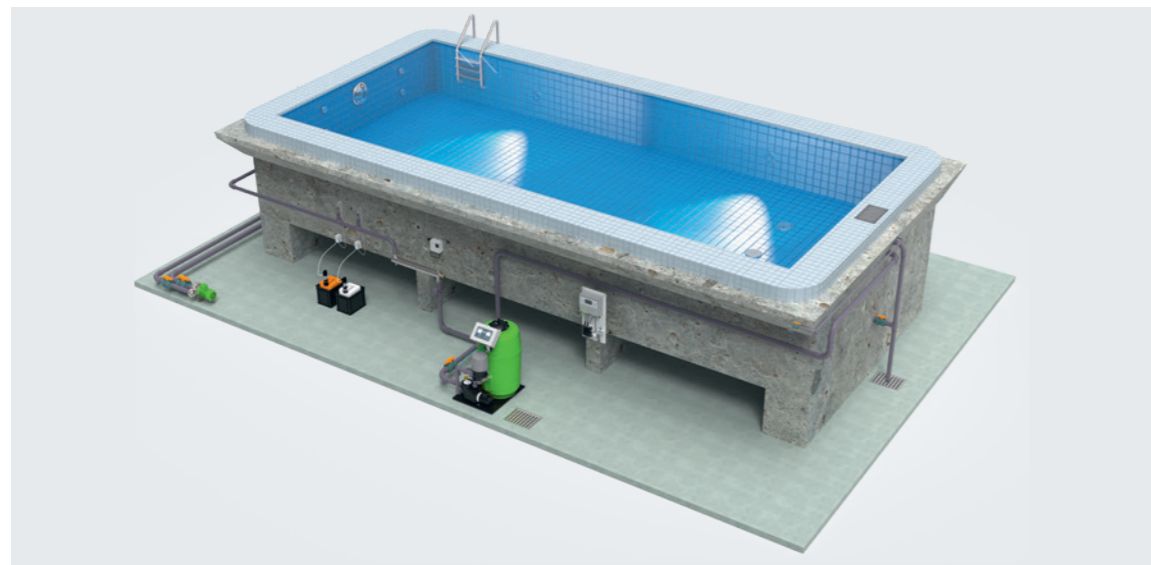
Anlagenbeispiel System Oberflächenabsaugung
